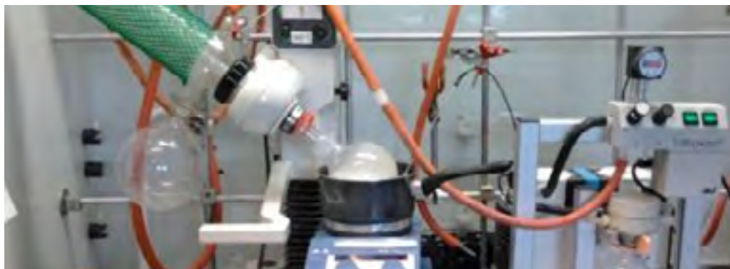
Figuur: Rotatiefilm verdamper opstelling voor synthese compatibilizer
